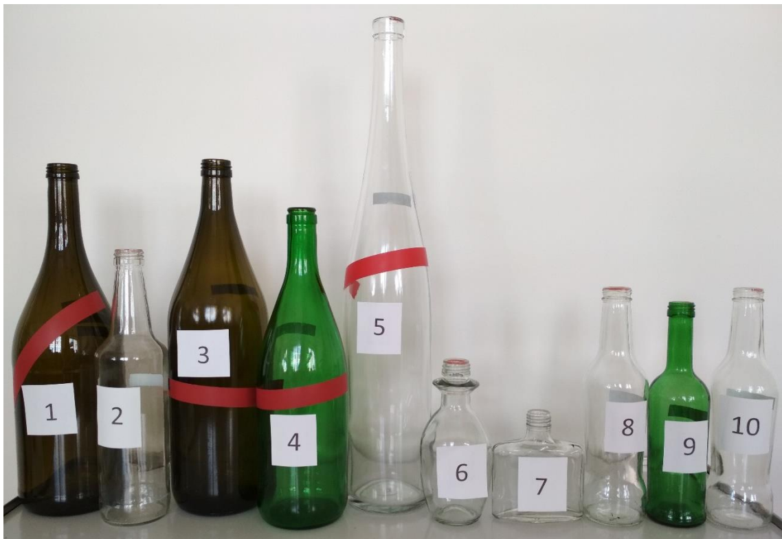
Obr. 4.6: Rigidní nádoby modelující poddajnost plicních kompartmentů
