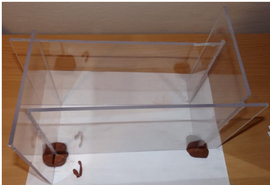
Obrázek 5.13: Provizorní fixace stěn bednění pomocí modelovací hmoty
