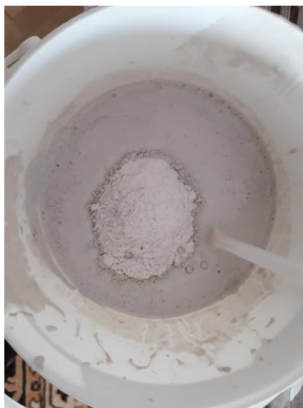
Obrázek 5.16: Příprava sádry na odlévání formy
