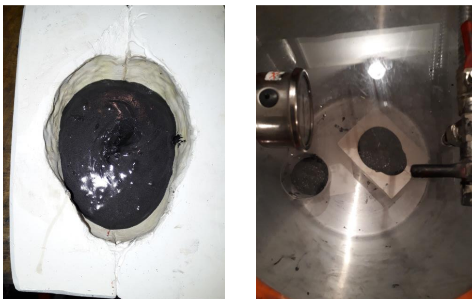
Obrázek 5.25: Vlevo směs pro fantom mozkomíšního moku ve formě, vpravo vakuování vrstvy (sádrová forma) a kontrolního vzorku (plastový kelímek)
