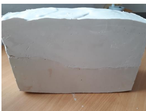
Obrázek 5.20: Hotová dvoudílná forma pro fantom kůže
