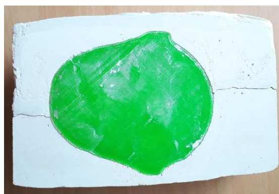
Obrázek 5.20: Hotová dvoudílná forma pro fantom kůže
