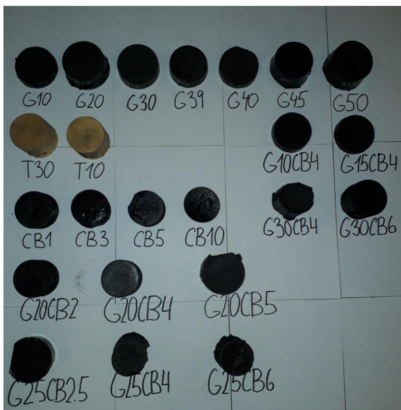
Obrázek 6.1: Vytvořené vzorky použitelných fantomů
