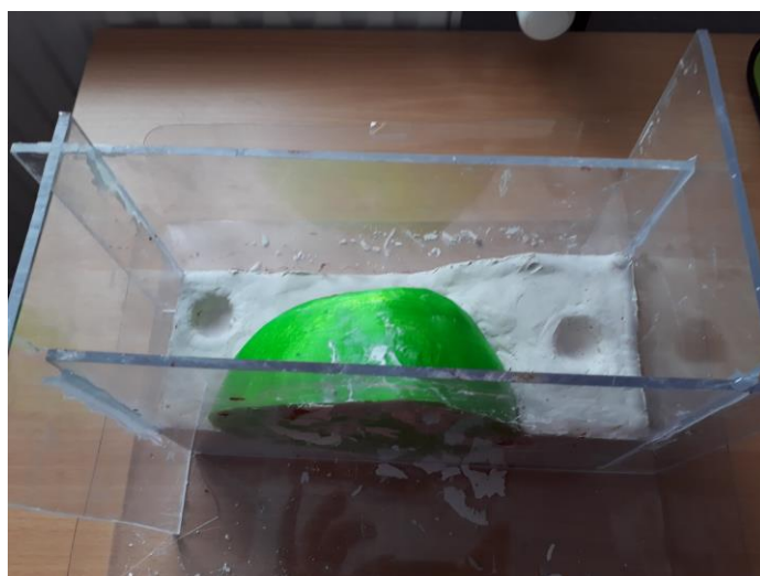
Obrázek 5.19: Připravené bednění na odlití druhého dílu formy
