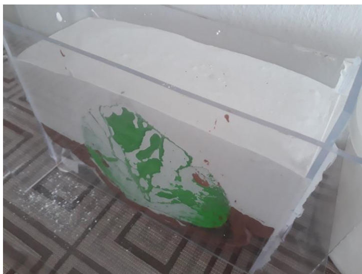
Obrázek 5.17: Odlití prvního dílu formy
