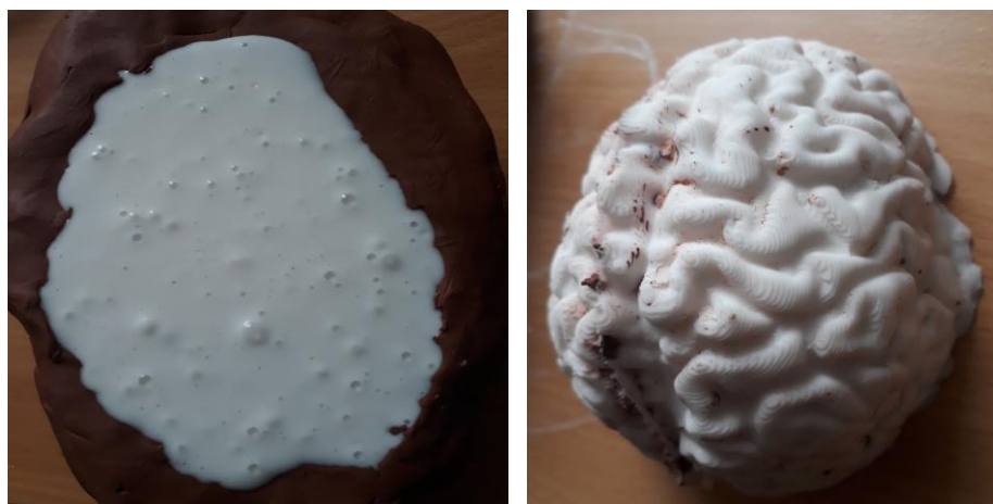
Obrázek 5.24: Vlevo nalitý kondenzační silikon ve formě. Vpravo hotový odlitek
